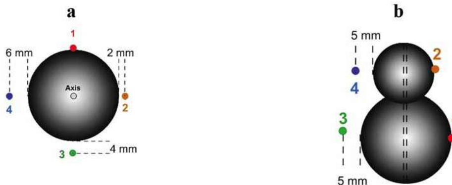
Рис. 1. Расположение оптических датчиков температуры в экваториальной плоскости сферического имплантата (а) и вокруг составного имплантата (б)
