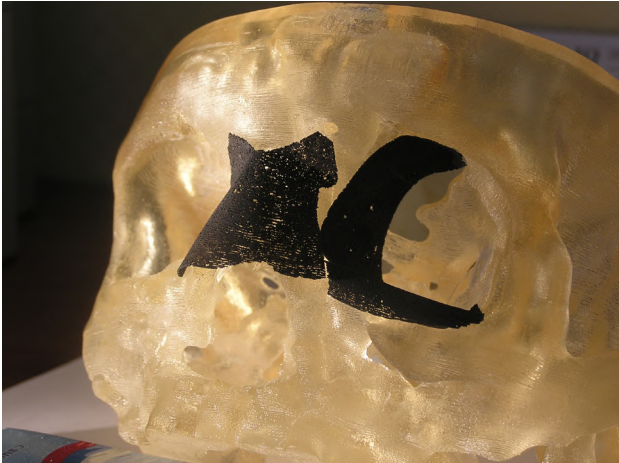
Рис. 2. Индивидуальный имплантат из никелида титана, изготовленный по стереолитографической модели пациента
