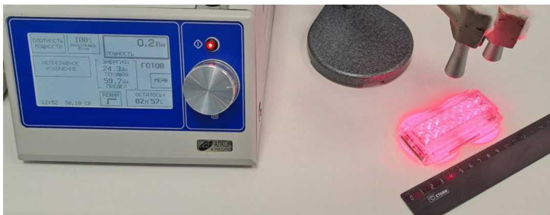
Рис. 1. Воздействие лазерным излучением на культуру клеток в планшете E-plate 16 Fig. 1. Laser irradiation of cell cultures in E-plate 16
